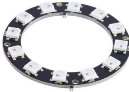
Рисунок 2.12 – Коло з 12 RGB світлодіодами WS2812 з послідовним керуванням
