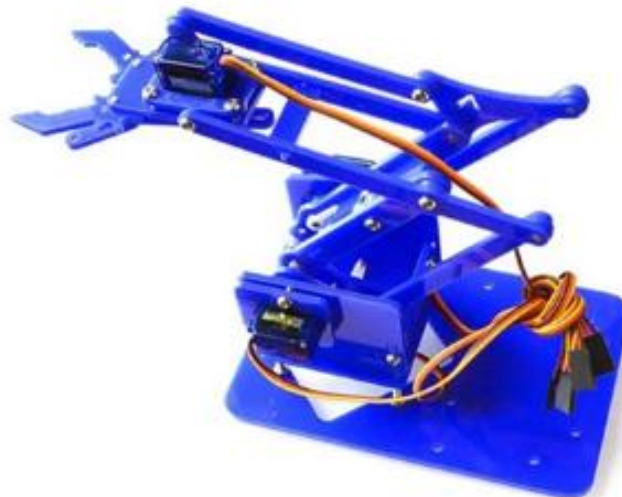
Рисунок 2.9 – Механічний маніпулятор для Arduino SG90 [16]
