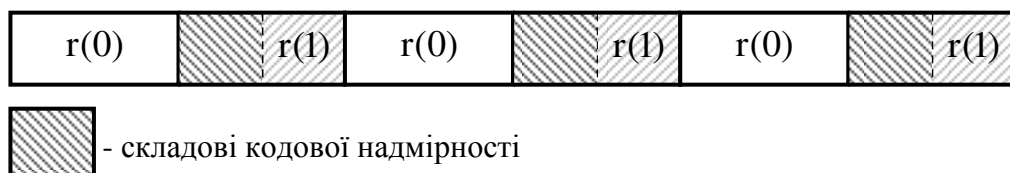
Рисунок 5.17 – Схема наявності кодової надмірності в послідовності довжин двійкових серій
