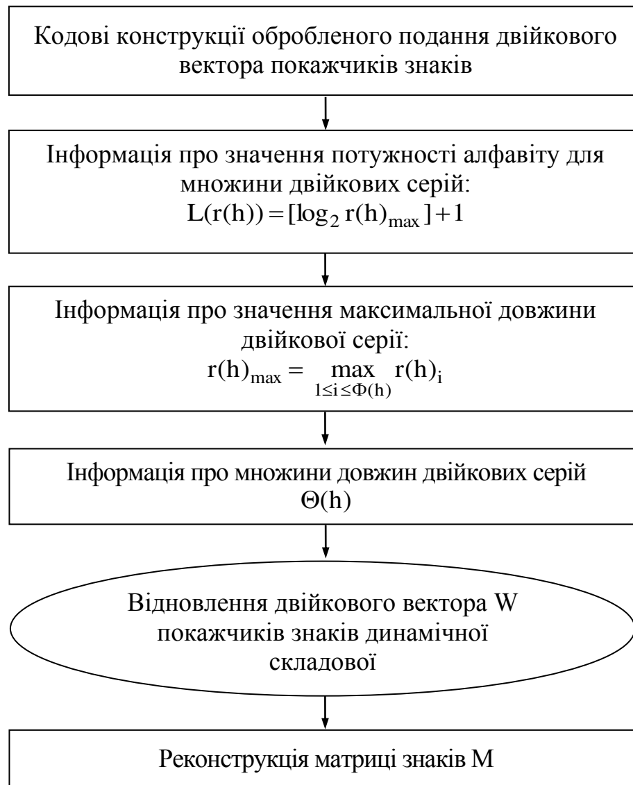
Рисунок 5.14 – Схема реконструкції двійкового вектора покажчика знаків динамічної складової
