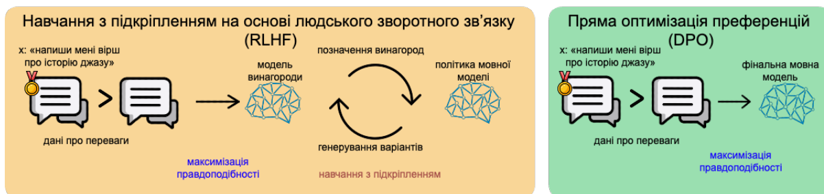
Рисунок 2.2 – Порівняння схем навчання моделей із використанням RLHF та DPO
