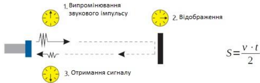
Рисунок 2.14 – Принцип роботи ультразвукового датчика
