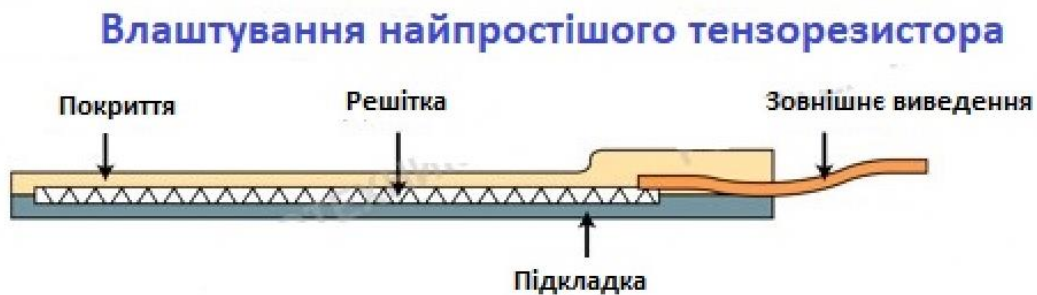
Рисунок 2.18 – Процес роботи тензодатчика
