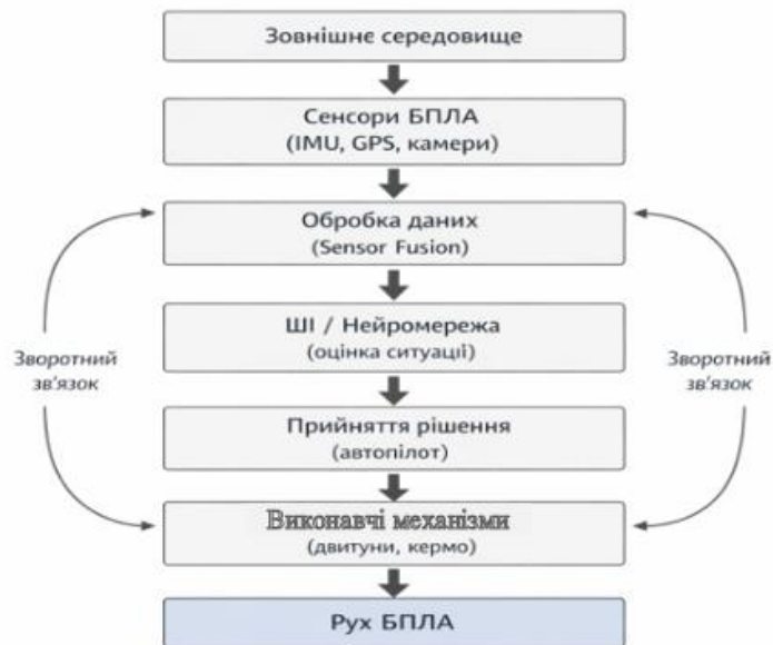
Рисунок 1 – Структура адаптивної системи автопілотування БПЛА
