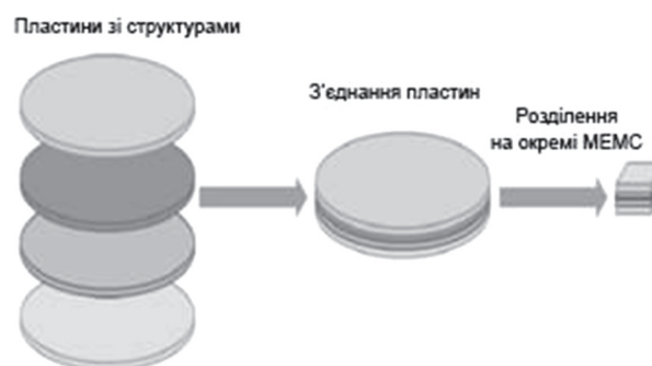
Рис. 1. WLP метод пакування МЕМС датчиків
