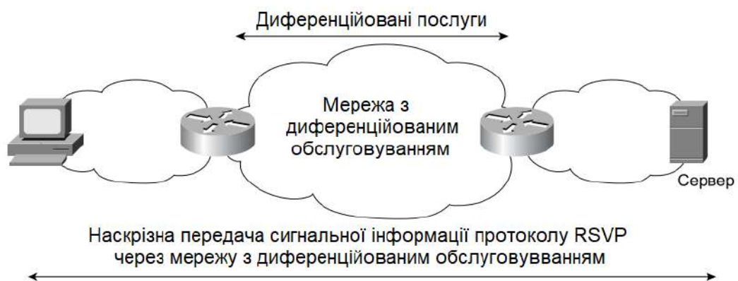
Рисунок 3.7 – Передача сигнальної інформації протоколу RSVP через DiffServ-мережу
