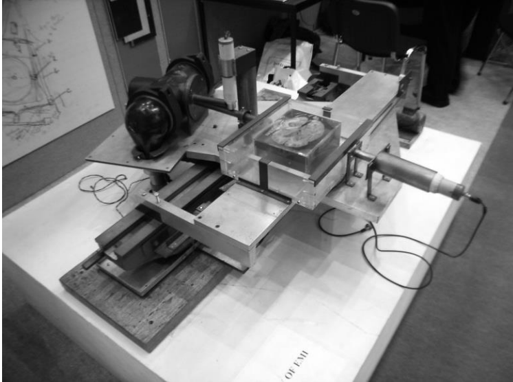
Перший прототип КТ-сканера, який розробив Хаунсфілд (Виставка UKRC 2005, Manchester G-MEX centre )
