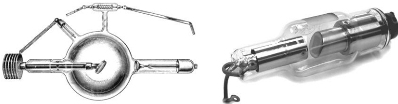
Рисунок 2.4 – Найпростіші трубки для генерації рентгенівського випромінювання: трубка Крукса [15] та General Electric D-1.7
