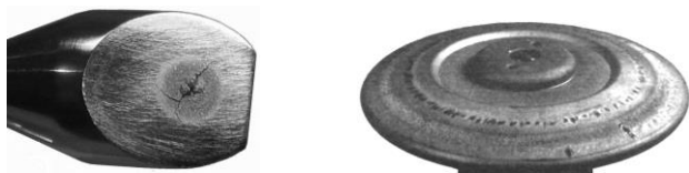
Рисунок 2.8 – Руйнування мішеней нерухомого та обертального анодів рентгенівських трубок через нерівномірний розігрів
