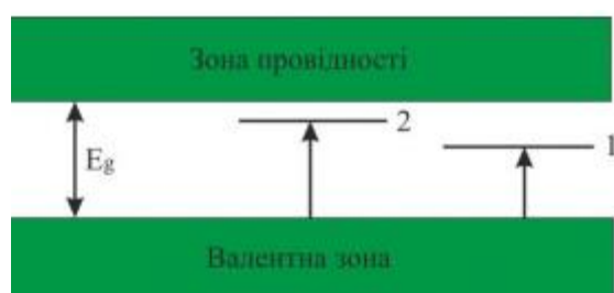
Рис. 1. Зонна схема напів- провідника
