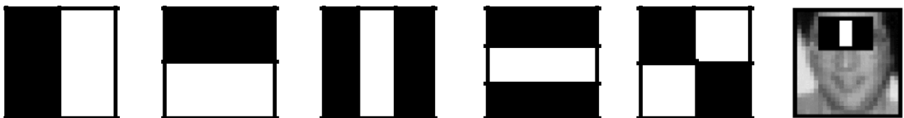
Рисунок 1 – Ознаки Хаара та приклад розташування ознаки щодо скануючого вікна
