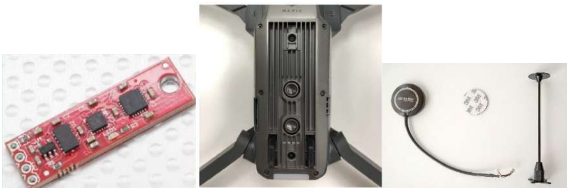
а) інерційні датчик б) одометр б) GPS-антена
