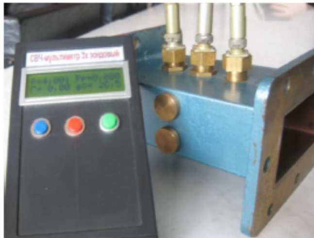
Рисунок 3.4 – Конструкція багатозондового НВЧ перетворювача з датчиками
