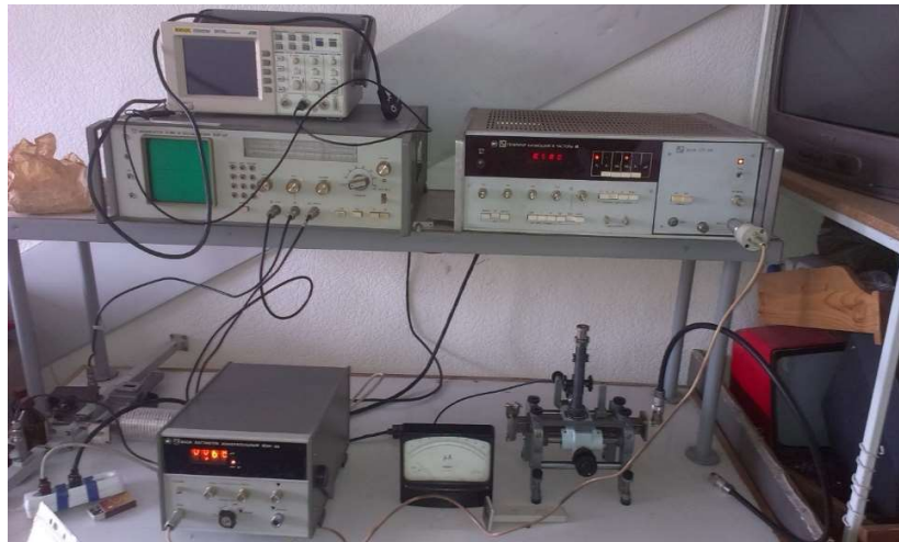
Рисунок 3.5 – Щілинна вимірювальна лінія на кафедрі ПЕЕА
