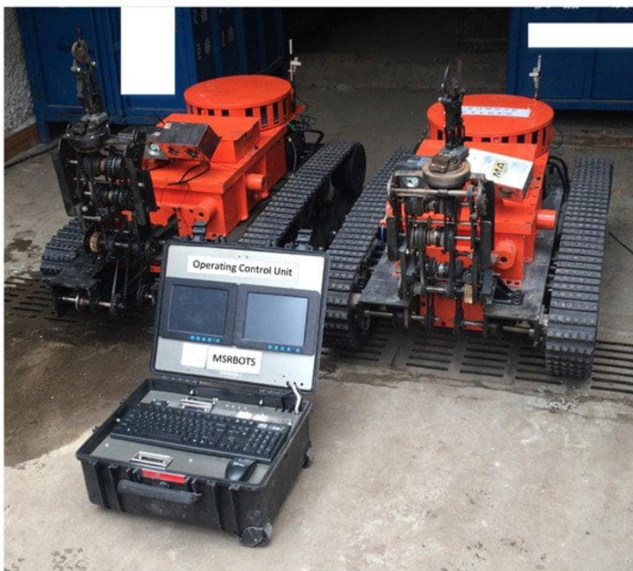
Рисунок 1 – Пошуково-рятувальна роботизована система, що використовується для дистанційного зондування довкілля підземної вугільної шахти. [1]
