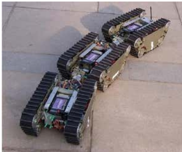
Рисунок 3 – Гусенечні роботи, схожі на танк, що дозволяють модулям підніматися сходами та долати нерівні поверхні [3]
