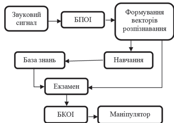
Рис. 1. Функціональна схема керування здатного навчатися маніпулятора
