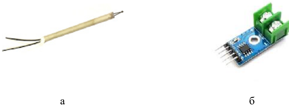
а) термопара ТХА; б) перетворювач МАХ6675.
