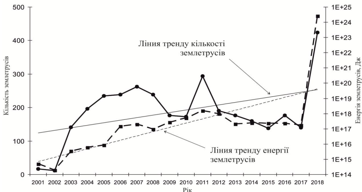
Рисунок 1.3 – Динаміка кількості землетрусів на Землі з магнітудою M \geq 5 і розрахованої їх сумарної енергії (результати представлені в логарифмічною шкалою) в період 2001–2018 рр.
