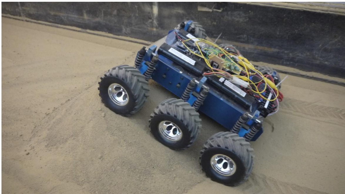
Рисунок 3.5 – РТЗ у колісному виконанні на похилому піщано-мулистому суглинку
