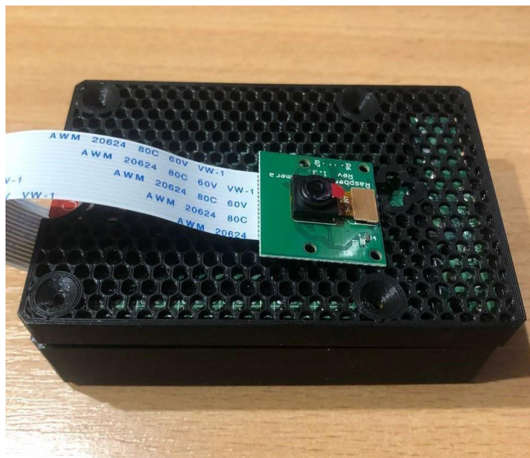
Рисунок 3.6 – Зібраний макет системи
