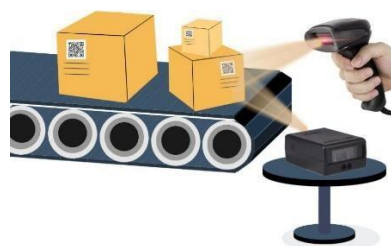
Рисунок 1.20 – Приклад використання QR-коду для розпізнавання об'єктів на виробничій лінії
