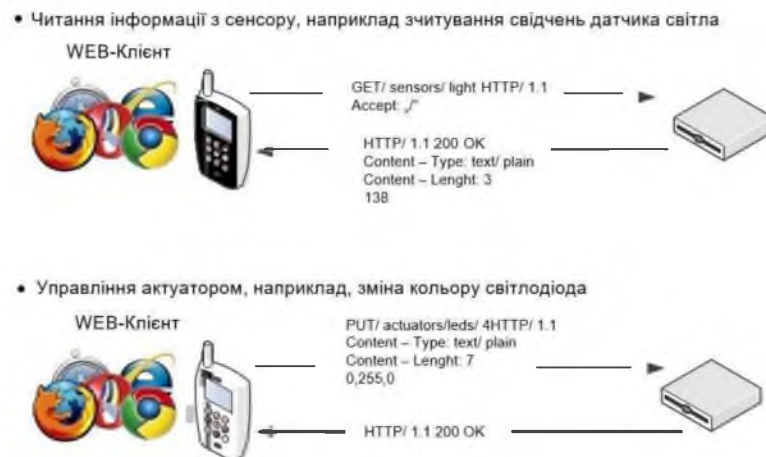
Рисунок 1 – Схема варіантів управління послугами та веб-взаємодії в NB-IoT4G-мережі
