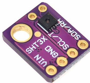
Рисунок 1.13 – Датчик SHT31 для одночасного вимірювання температури і вологості [16]
