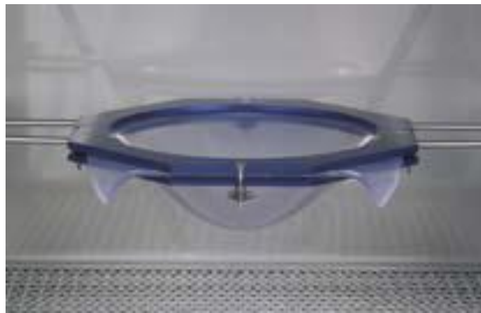
Рисунок 1.13 – Закріплення листової заготовки в затискній рамі пристрою глибокої витяжки
