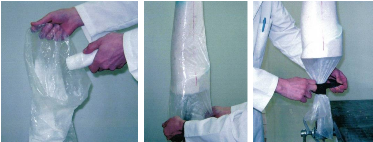
Рисунок 1.15 – Підготовка гіпсової моделі й армуючої системи
