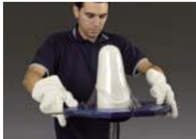
Рисунок 1.14 – Формування методом глибокої витяжки:
