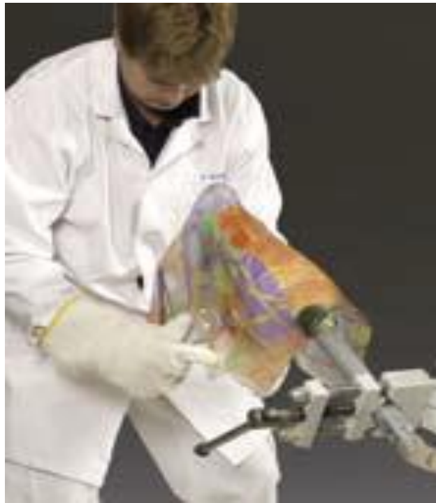
Рисунок 1.12 – Закріплення заготовки на гіпсовій моделі під час вакуумного термоформування
