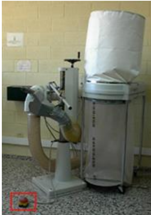
Рисунок 3.1 – Пристрій безпеки/захисту (запобіжник), який перериває подачу електроенергії в надзвичайній ситуації
