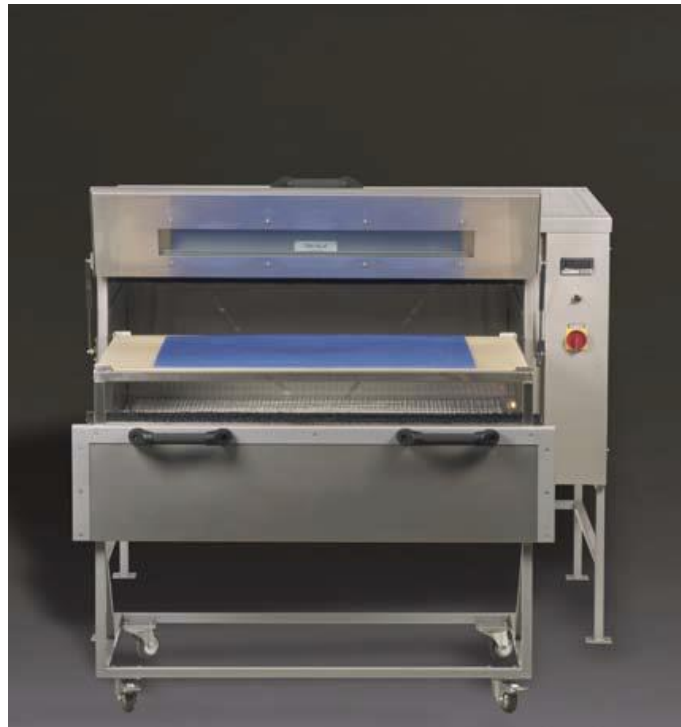
Рисунок 1.10 – Нагрів пластика в термошафах з інфрачервоними обігрівачами
