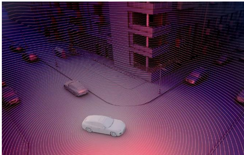
Рисунок 1.9 – Автономний автомобіль використовує датчики LIDAR для виявлення навколишніх будівель і автомобілів
