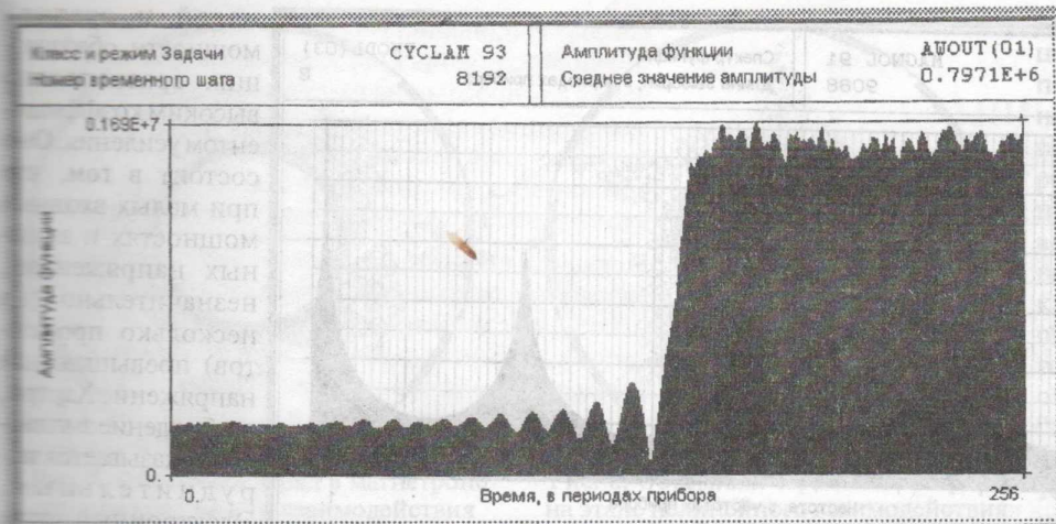
Рис. 2. Временная зависимость амплитуды выходного сигнала амплитрона
