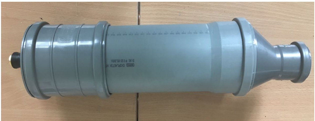
Рисунок 2.10 – Ємність для завантаження і подачі кераміки
