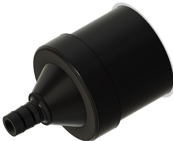
Рисунок 2.12 – Модель перехідника від модуля подачі до модуля екструзії
