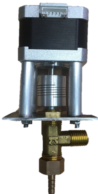
Рисунок 3.8 – Механізм екструзії кераміки
