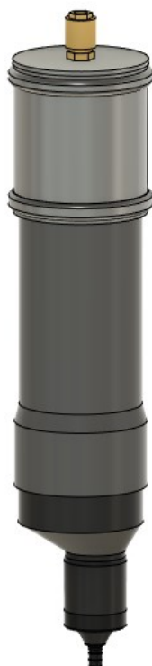
Рисунок 2.8 – Модель ємності для завантаження і подачі кераміки до екструдера
