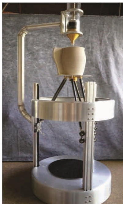
Рисунок 1.4 – 3D-принтер 3D PotterBot з поршневим екструдером
