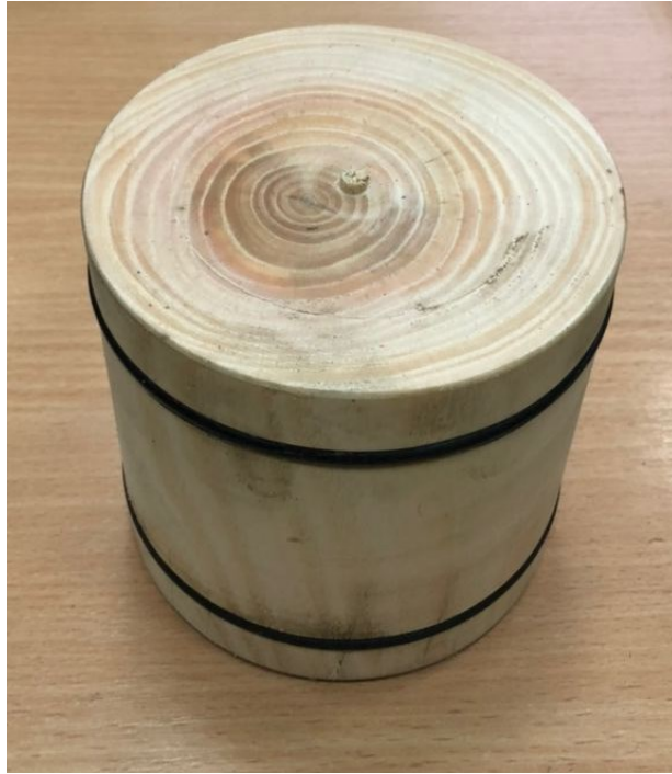
Рисунок 2.14 – Поршень для проштовхування кераміки у модулі подачі
