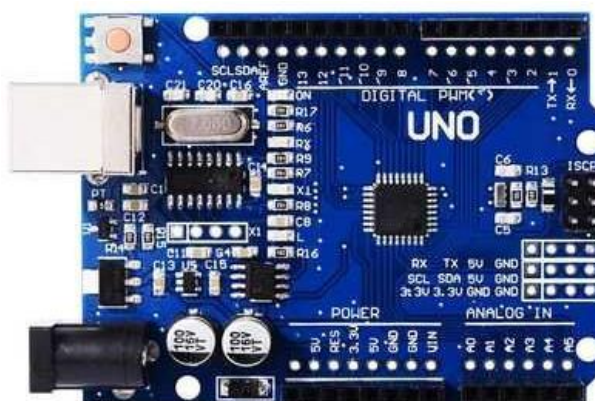
Рисунок 3.1 – Мікроконтролер Arduino UNO, обраний для реалізації пульта
