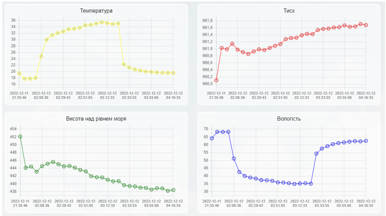
Рисунок 4.3 – Графіки вимірювань в умовах високої температури
