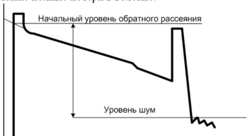
Рис. 1. Пример рефлектограммы оптического волокна
