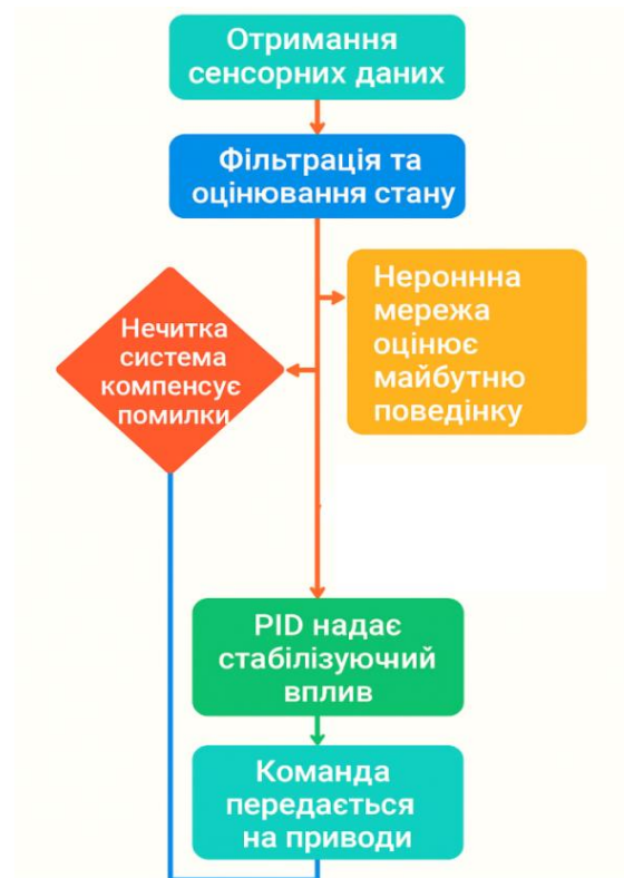
Рисунок 3.8 – Алгоритм функціонування гібридної системи керування
