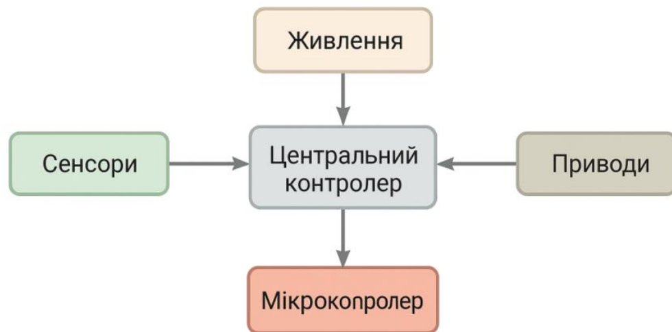
Рисунок 3.2 – Апаратна архітектура системи керування роботом-собакою
