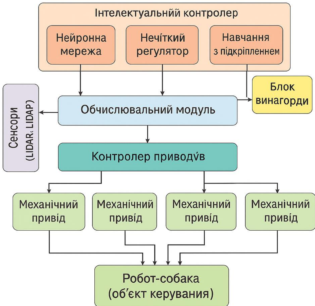
Рисунок 2.1 – Узагальнена структурна схема системи керування роботом-собакою
