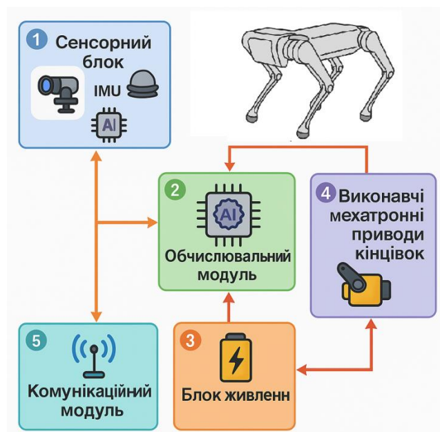
Рисунок 1.1 – Узагальнена структурна схема біонічного робота-собаки
