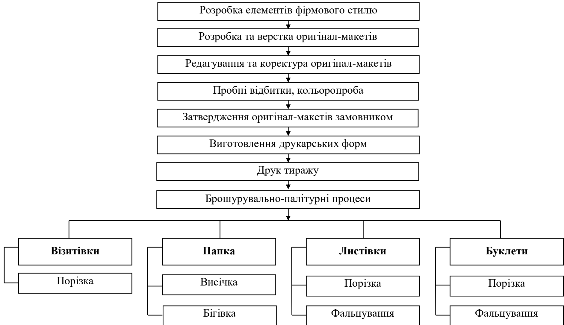
Рисунок 5.1 – Технологічна схема виготовлення рекламної продукції
