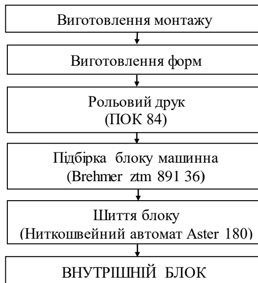
Рисунок 5.7 – Схема технологічних процесів для основного блоку «100 казок»
