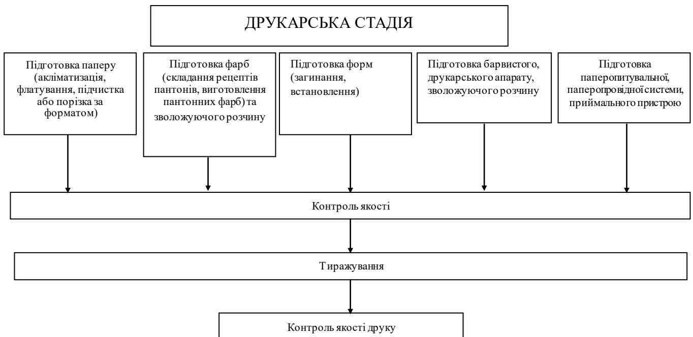
Рисунок 5.3 – Технологічна схема друкарського процесу
