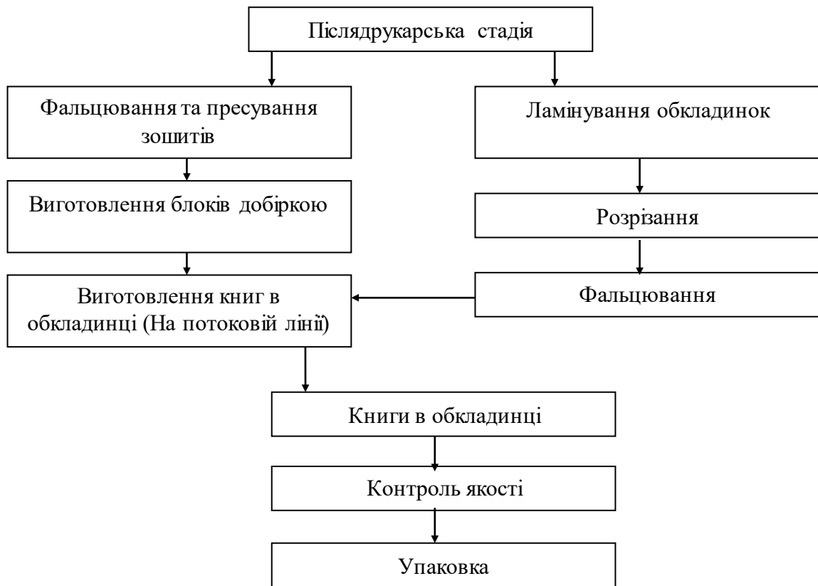
Рисунок 5.4 – Схема післядрукарських процесів
