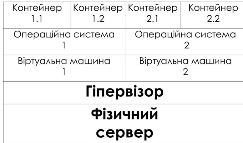
Рисунок 1 – Рівні віртуалізації обчислювального процесу
