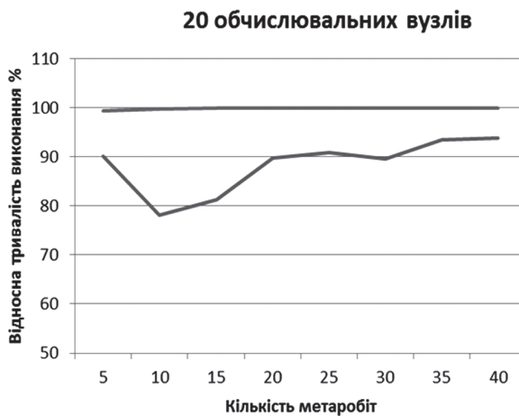
Рис. 4. Відносна тривалість виконання робіт без координатора (NEFT) та за методом пріоритету найскладнішої роботи (NEFT+CF) для грід з 20 вузлами
