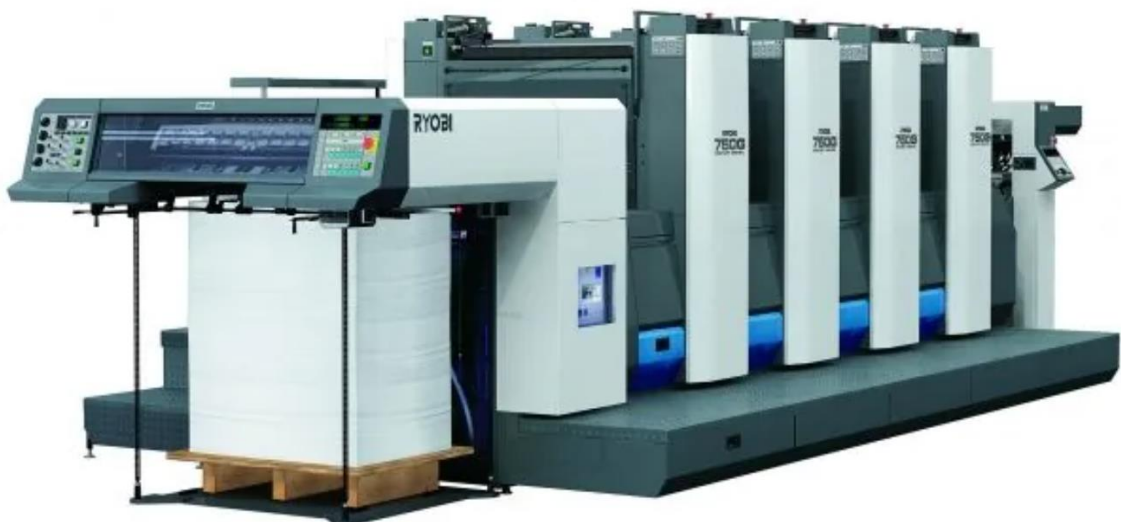
Рисунок 5.1 – Офсетна 4-фарбова аркушева друкарська машина Ryobi 754
