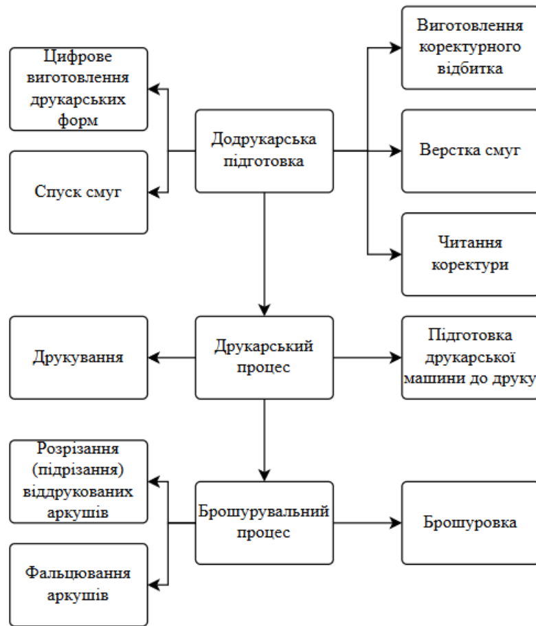
Рисунок 4.1 – Схема технологічного процесу виготовлення журналу
