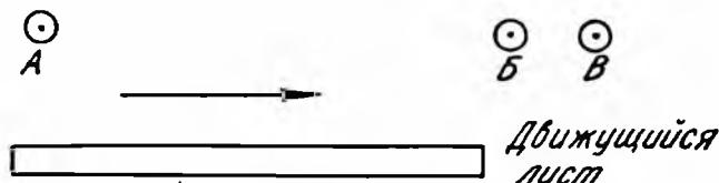
Рис. 1. Схема размещения датчиков над транспортером.
