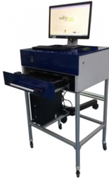
Рисунок 1.2 – Приклад автоматизованої системи оптичного контролю ДП SMT IS-S [17]
