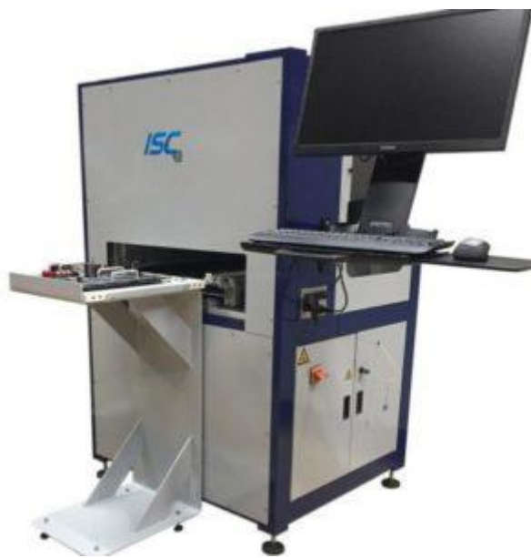
Рисунок 1.1 – Приклад автоматизованої системи оптичного контролю ДП SMT IS-C [17]
