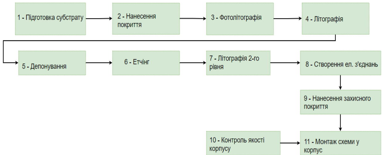
Рисунок 2.1 – Структурна схема ТП виробництва МЕМС акселерометрів.
