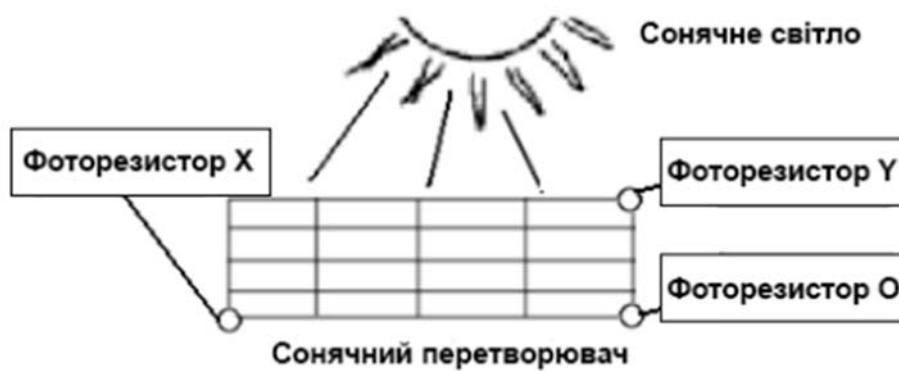
Рисунок 2.2 – Розташування фоторезисторів по схемі ХОУ на сонячному перетворювачі [14]
