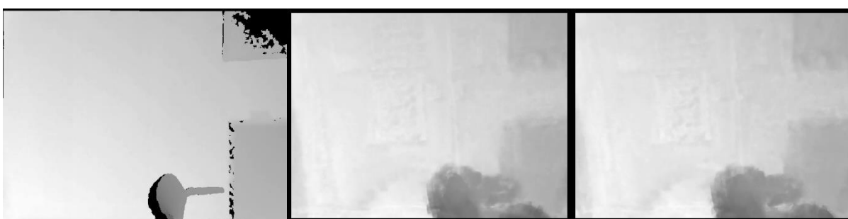
Рисунок А.6 – Результати реконструкції карт глибин на 150 кадри сцени 0005_00 ScanNet моделей (зліва направо): реальне зображення, PNeRF, модифікований PNeRF
