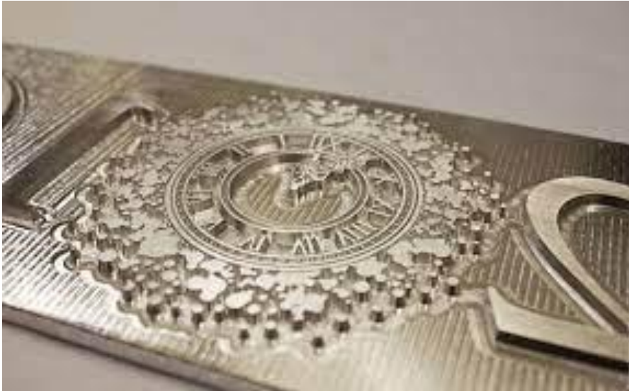
Рисунок 11 – Приклад кліше (штампу) для тиснення
