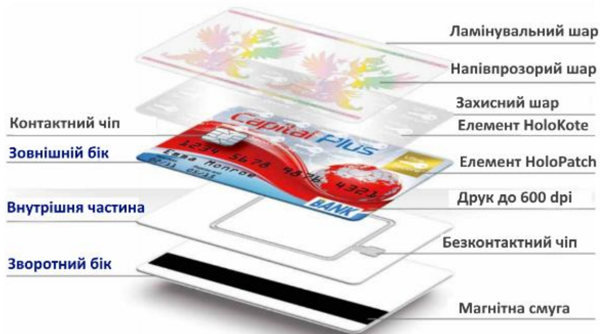
Рисунок 10 – Приклад застосування багатошарового ламінування
