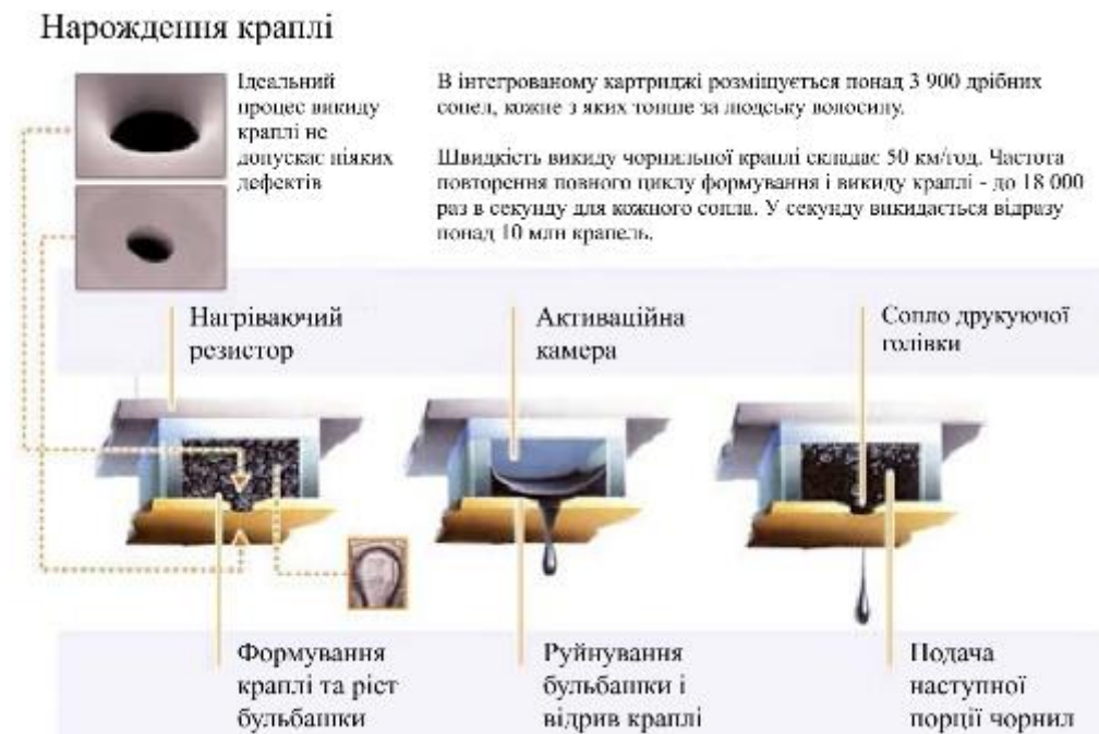
Рисунок 3.2 – Технологія викиду краплі в термічних пристроях
