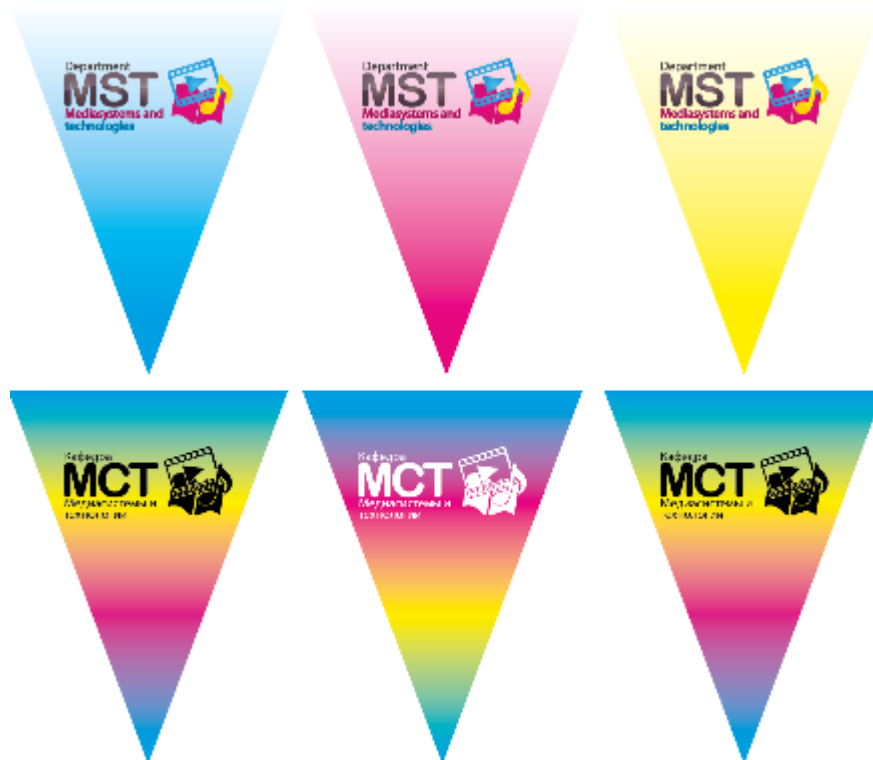
Рисунок 5.6 – Тест-об'єкт для визначення показника «Лінійність градієнту»
