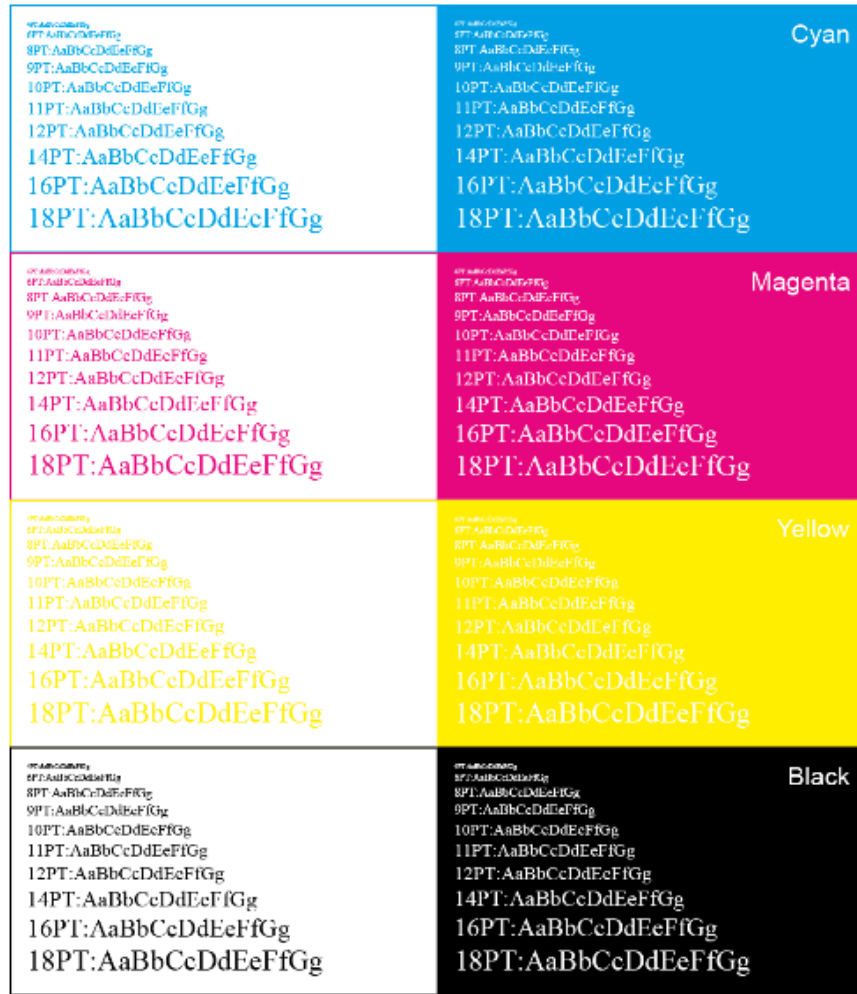
Рисунок 5.11 – Тест-об'єкт для визначення відтворення шрифтів
