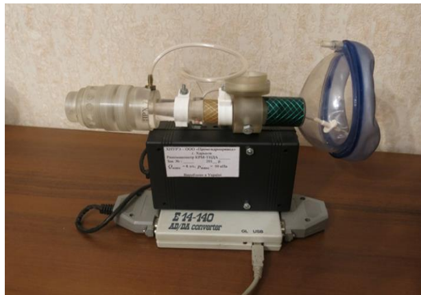
Рисунок 6.8 – Комп'ютерний риноманометр ТНДА-ПРХ з ольфактометричною насадкою
