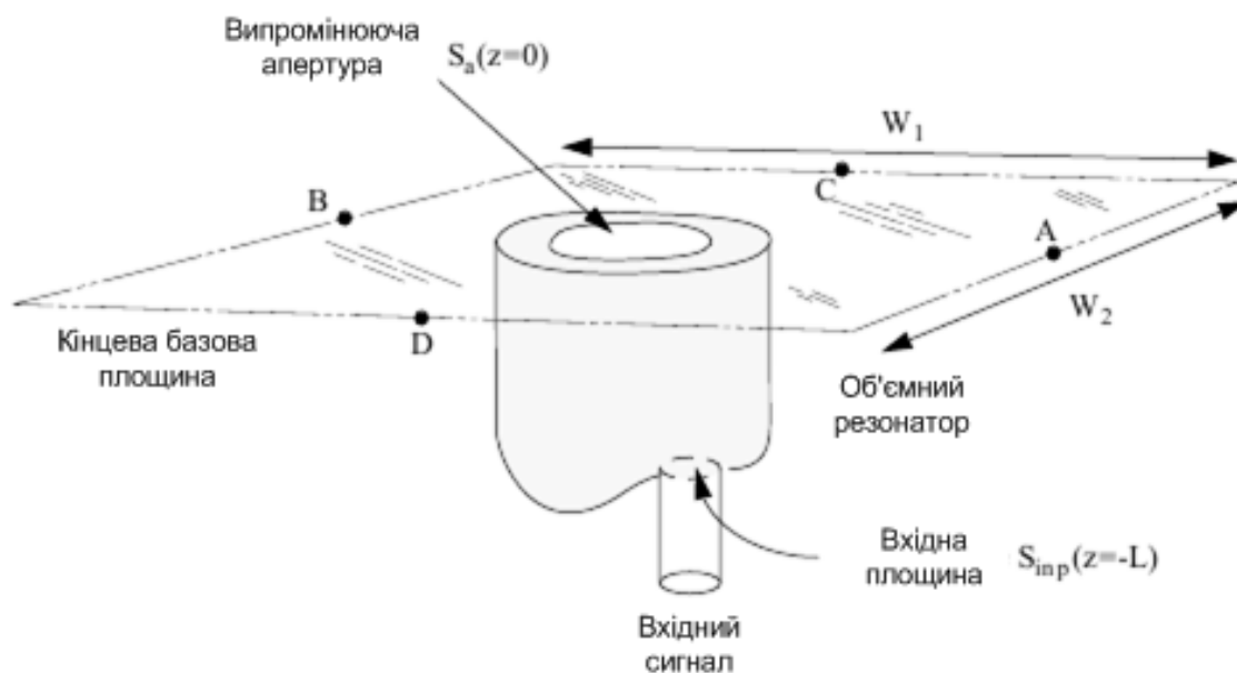
Рисунок 2.2 – Кругла випромінююча апертура на площині
