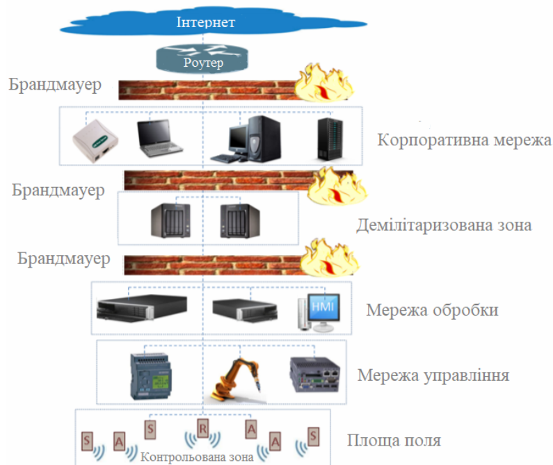
Рисунок 1 – Типові зв'язки промислової автоматизації і контролюючих систем з корпоративними мережами й Інтернетом
