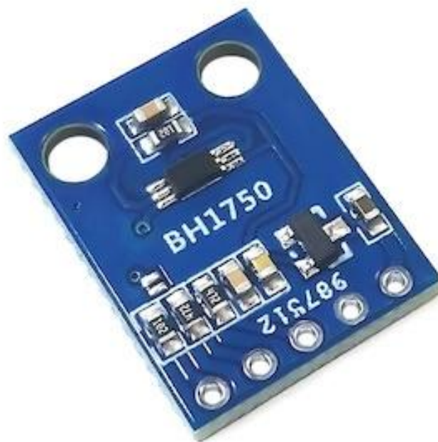
Рисунок 2.3 – Сенсор освітленості BH1750
