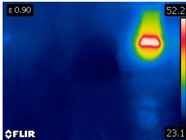
Рисунок 4.33 – Термограма скляної пластини з зовнішньою завадою з дистанції 50 см
