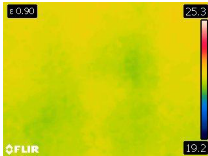
Рисунок 4.46 – Термограма пластикової картки з дистанції 1,5 м
