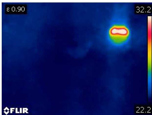
Рисунок 4.16 – Термограма металевого шківу з зовнішньою завадою з дистанції 50 см
