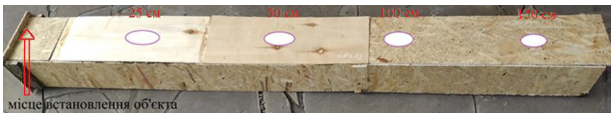
Рисунок 4.4 – Лабораторний макет для проведення експерименту з визначення дальності дії тепловізійної системи
