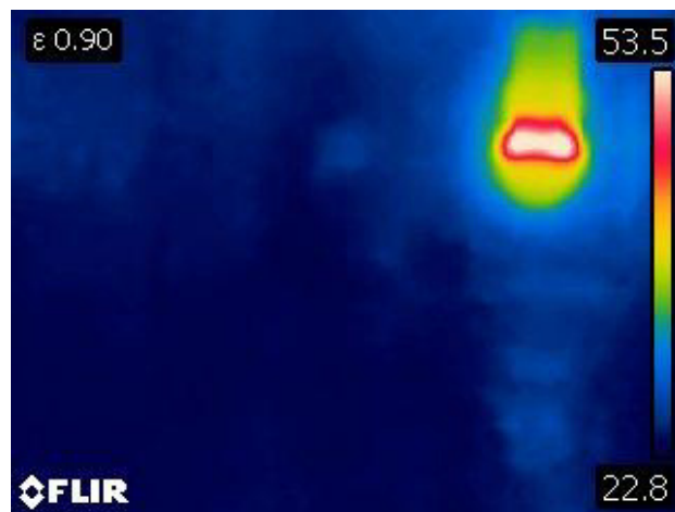
Рисунок 4.50 – Термограма скляної пластини з зовнішньою завадою з дистанції 50 см
