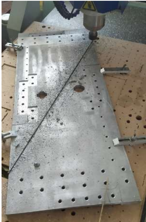
Рисунок 2.8 – Фрезерування стійок порталу
