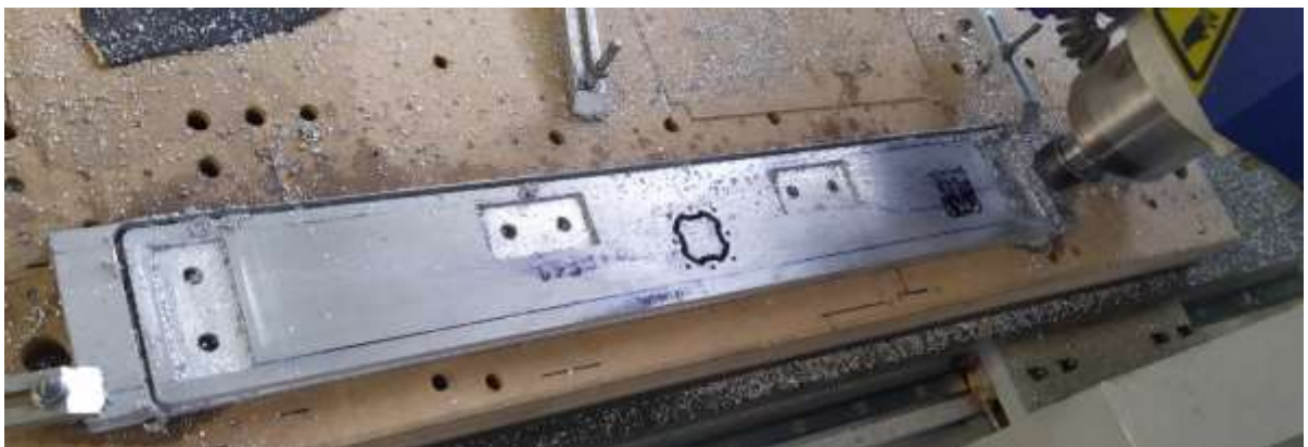
Рисунок 2.9 – Фрезерування передньої пластини верстата
