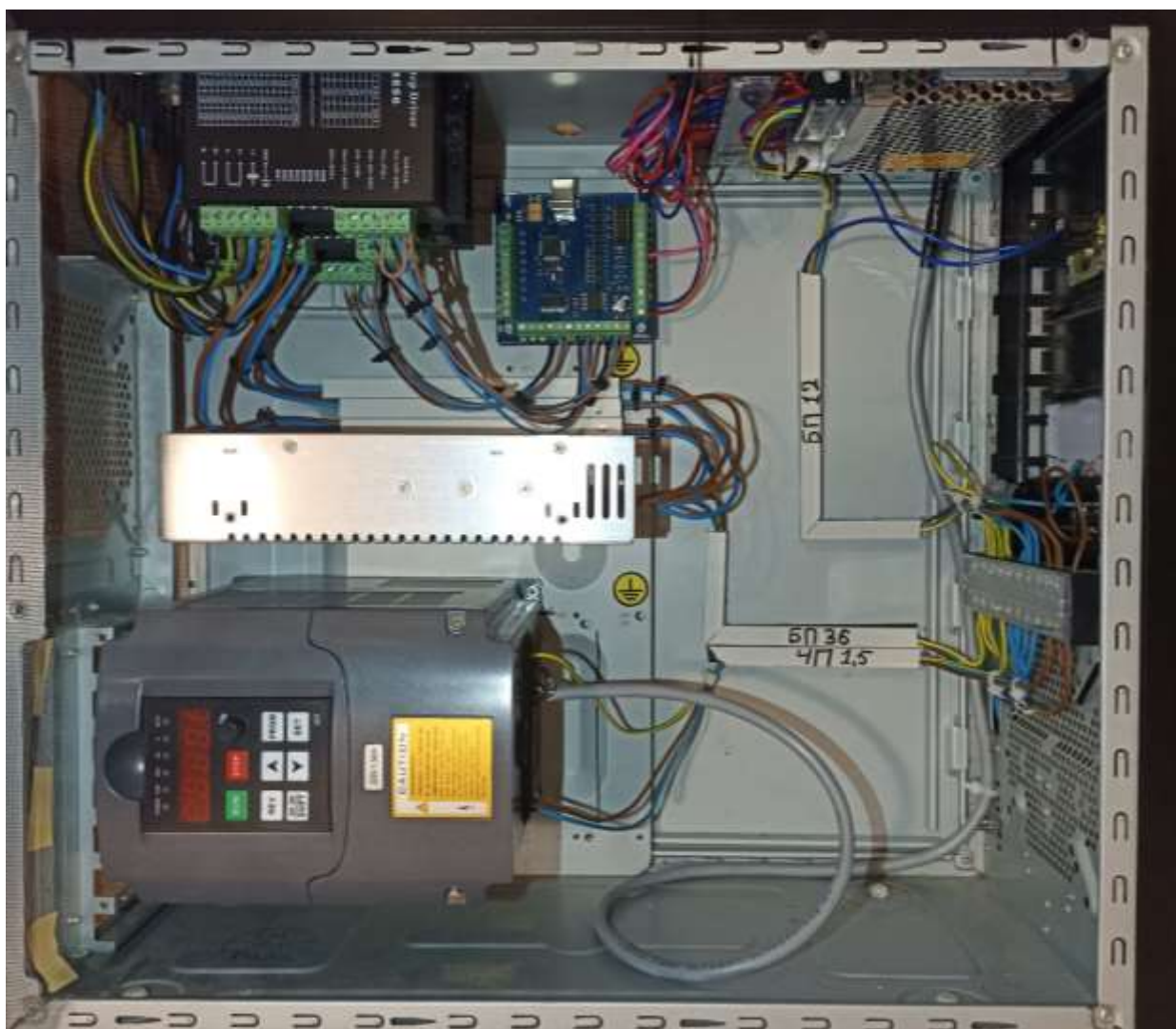
Рисунок 2.27 – Зібрана електронна частина верстата
