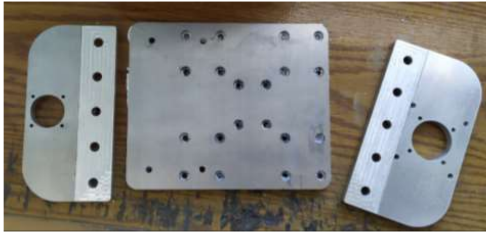
Рисунок 2.10 – Фрезерування пластин для вісі Z
