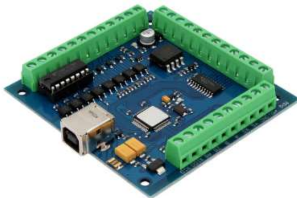
Рисунок 2.21 – Mach3 USB ST-USB STB4100
