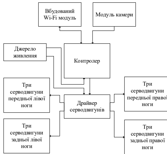
Рисунок 1 – Структурна схема робототехнічної платформи
