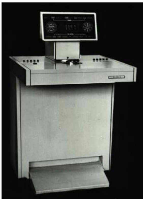
Рисунок 4.5 – Напівавтоматична установка «Експрес-4» для контролю геометричних властивостей КС
