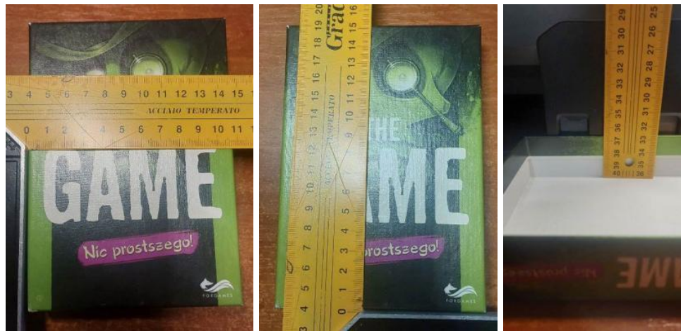
Рисунок 5.2 – Забір розміру кришки двокомпонентної коробки в настільної гри «The Game: Quick & Easy» (А – ширина, Б – висота, В – глибина)
