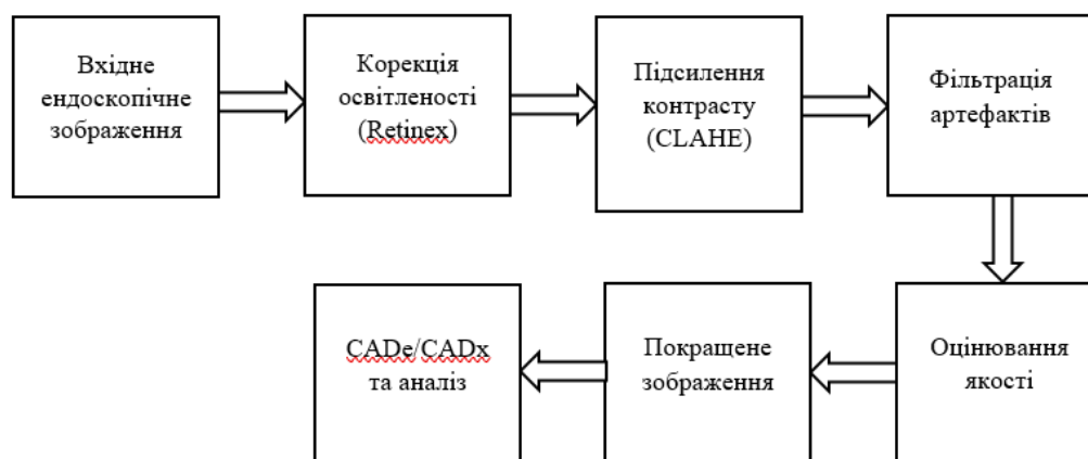
Рис. 1. Структурна схема комбінованого підходу до покращення ендоскопічних зображень
